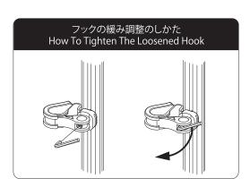
もしフックを押し下げても動いてしまうくらい緩い場合は、M4六角レンチでボルトを少し締め込んで調整します。 If the hook has been loosened, slightly tighten the inside bolt with M4 hex wrench.
