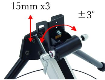
FG550Aのフォーク受け部は車体に合わせて、15mmピッチで三段階に高さを調整でき、かつ左右に3度ずつ角度を修正することができます。
