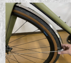
ステアをフォークに固定しフェンダーにあててみる (タイヤとの間隔が均等だとカッコイイ)
