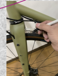
吊り金具を仮止めし、取り付け位置をマークする
