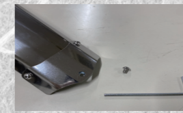
真ん中のねじを外し、左右のねじは緩める
