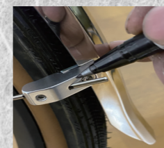
ステアの飛出しをマークする
